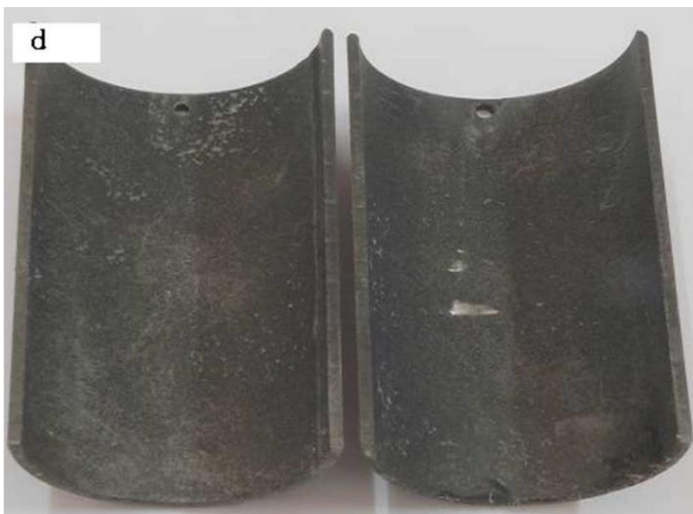
Сурет 2.7 - Әр түрлі беттерде АШПШ-ның тұну үлгілері. а – I үлгі: Zn-Fe жабыны, b – III үлгі: Zn-Ni-Fe жабыны, c – V үлгі: Zn-Fe-P жабыны, d – VII үлгі: Zn-Ni-Fe-P жабыны
