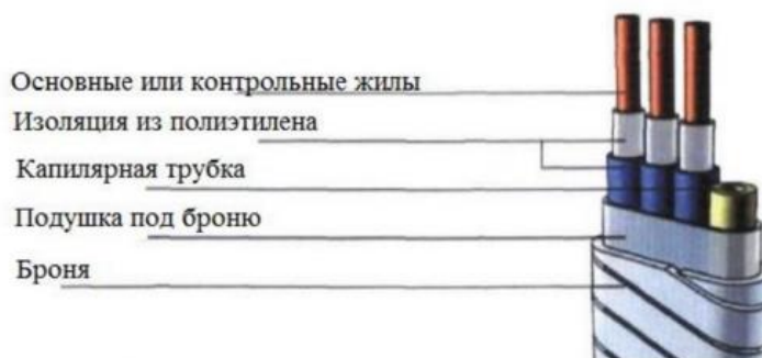
Сурет – 2.3 - Арнайы суасты кабельдік құрылғының дизайны.
